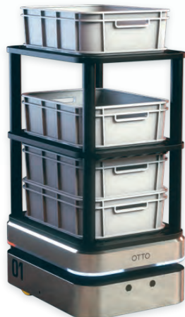
OTTO 100 100キロまで積載可。機械本体のソフトウェアに倉庫内の各種情報をインプットしてあるため自走が可能で、ピッキング、梱包、配送作業の人的ミスを最小化できる。
